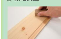
必要に応じて、サンドペーパー#240以上で研磨し、平滑な面に仕上げてください。
